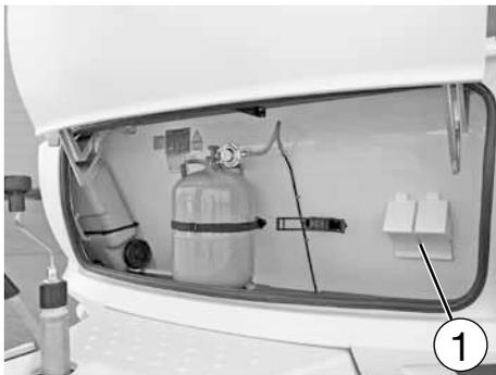
Unterlegkeile im Gasflaschenkasten
