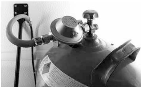
Anschluss des Gasreglers an die Gasflasche
